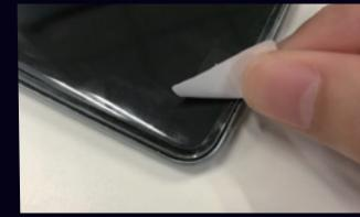
④画面にガラスフィルムを貼り終えたら貼り付け補助ラベルを剥がします。
